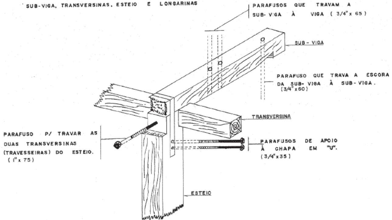
Figura 02: Detalhe de Transversinas e Sub-vigas
