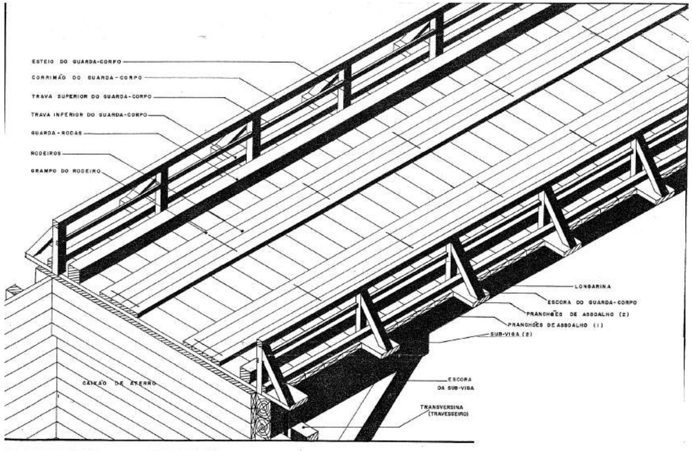
Figura 04: Vista Geral de uma ponte de madeira
