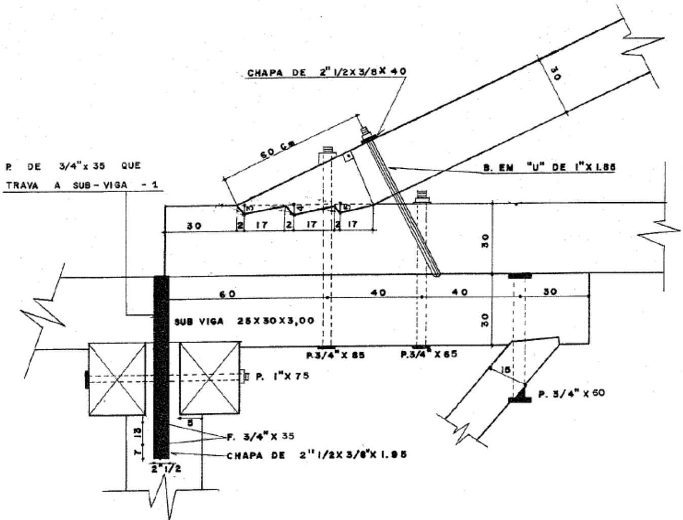
Figura 08: Detalhe em caixa da diagonal do banzo
