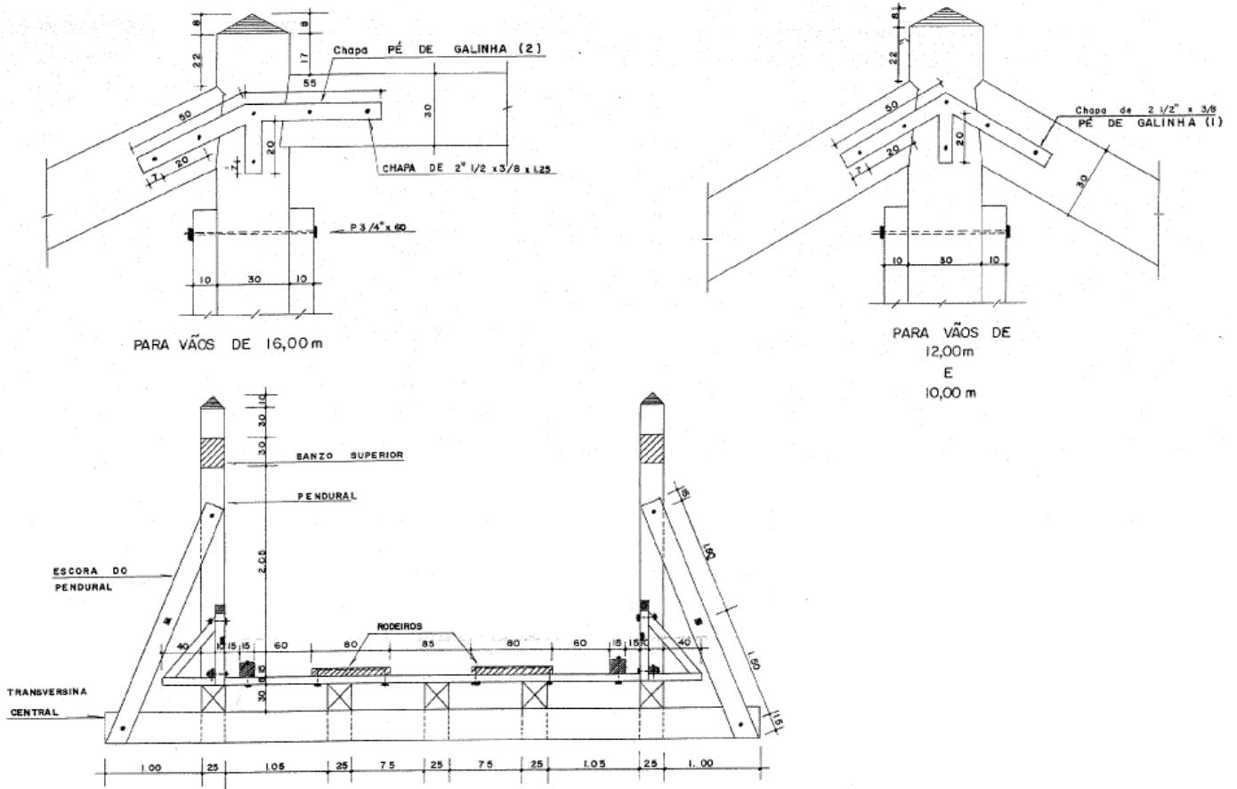
Figura 06: Detalhes de estruturas de banzos
