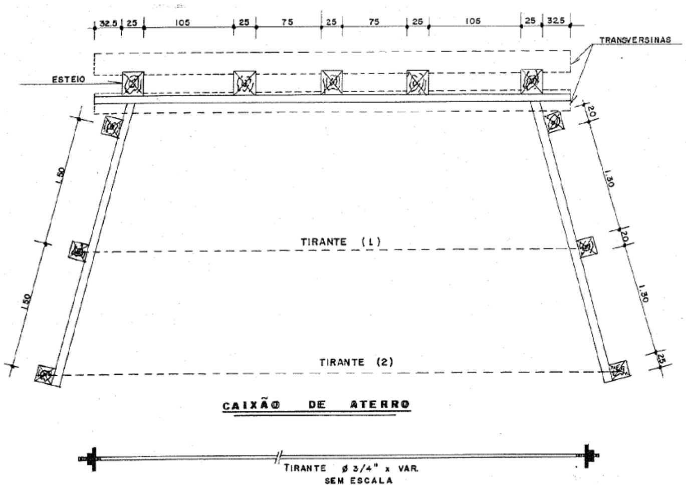
Figura 10: Detalhe de caixão de aterro
