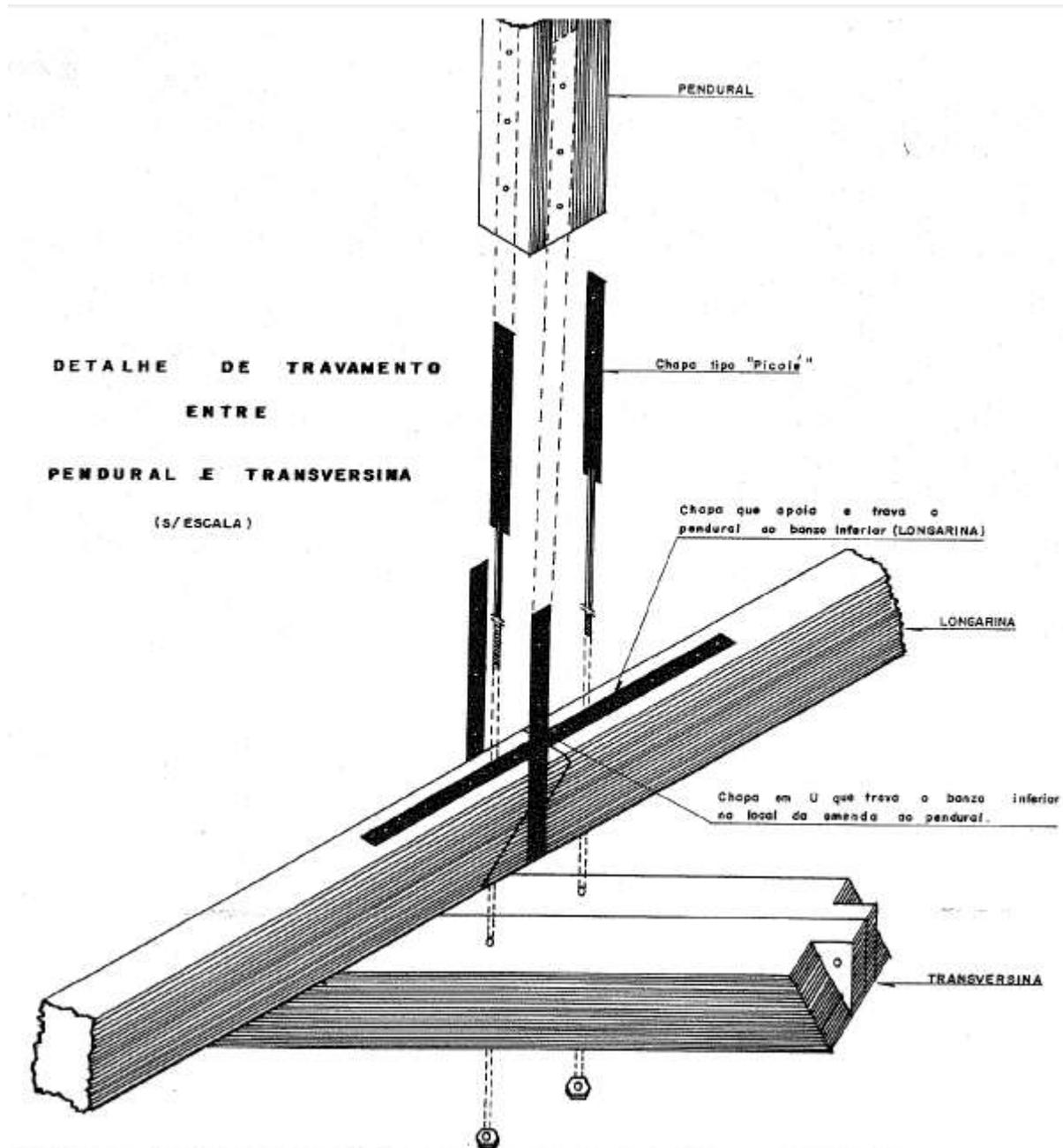
Figura 09: Detalhe de travamento entre pendural e transversina
