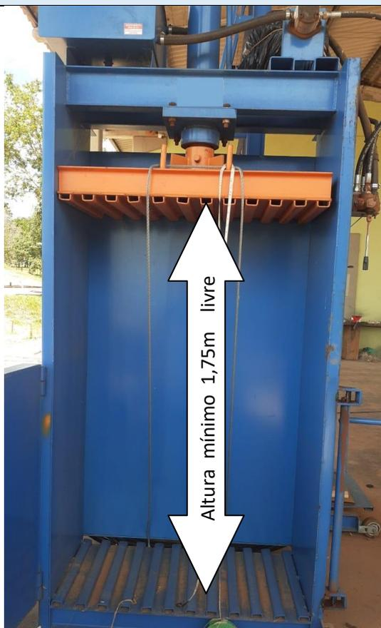
Foto meramente ilustrativa – caixa de prensagem altura livre mínimo 1,75m
